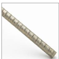
Filetage standard Dywidag. Norme NF P 93-350. Tiges cintrables et soudables. Charge d'utilisation (plusieurs utilisations) 172 kN.
