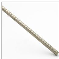
Filetage standard Dywidag. Norme NF P 93-350. Tiges cintrables et soudables. Charge d'utilisation (plusieurs utilisations) 90 kN
